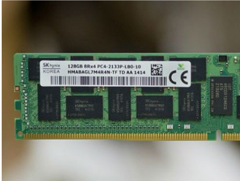
Μνήμη DDR4 / 128 GB / 2133 MHz της εταιρείας SK Hynix (V=1,2 volt με 16 IC των 8 GB , bus 64 bit / lithography 20 nm για Server με XEON E5)
