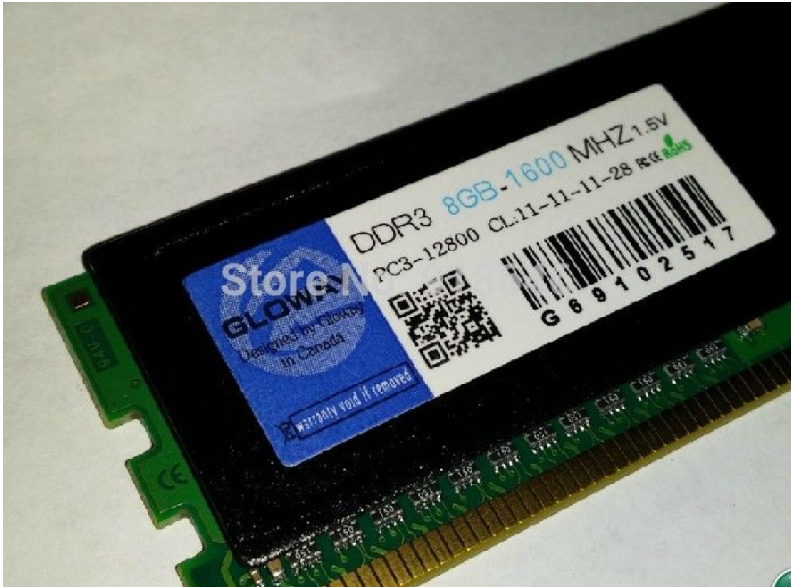
Χαρακτηριστικά μιας μνήμης DDR3 / 8GB / 1600 MHz
