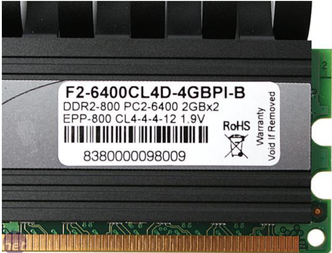
Χαρακτηριστικά μιας μνήμης (ζευγάρι των δύο αρθρωμάτων) DDR2 / 2GB / 800 MHz
