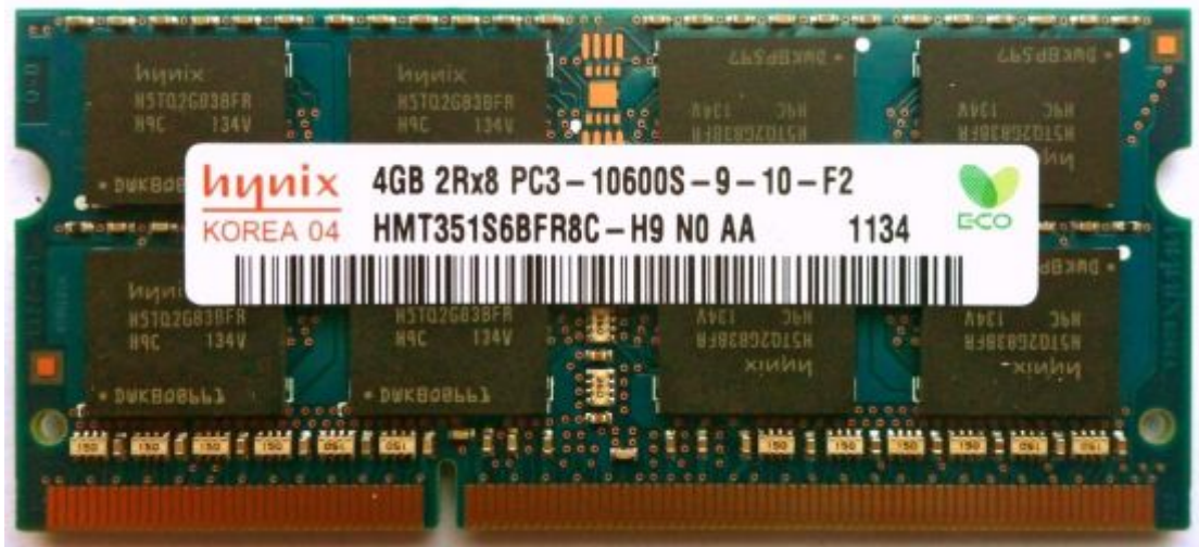
Μνήμη SO DIMM DDR3 / 4GB / 1333 MHz / 204 pins
