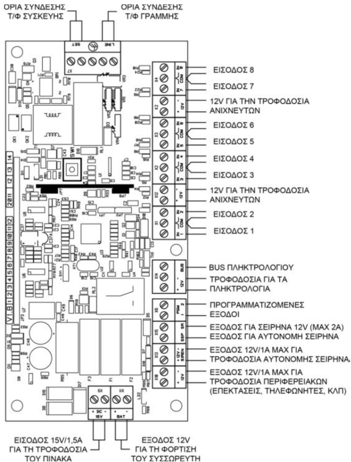
Επεξήγηση των συνδέσεων στο S PRO 64 της SIGMA
