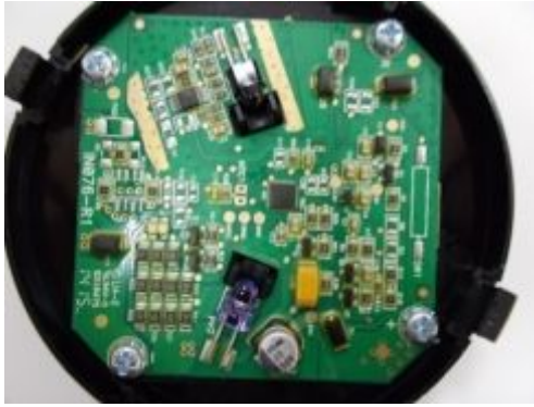
Η πλακέτα (διακρίνεται ο πομποδέκτης υπέρυθρων) Συνδεσμολογία (+ - → Κοκ/Μα NC → Πρ/Κιτ)
