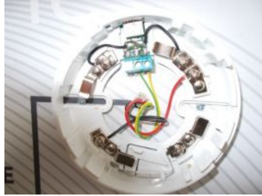
Η πλακέτα (διακρίνεται ο πομποδέκτης υπέρυθρων) Συνδεσμολογία (+ - → Κοκ/Μα NC → Πρ/Κιτ)
